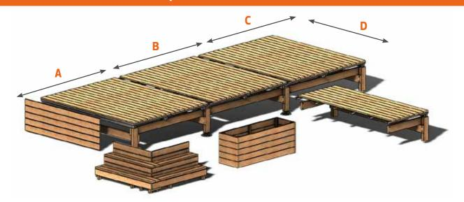
**LAMES en pin 120 x 28 mm** (longueur x épaisseur) LARGEUR 2,50 ou 3 mètres Dimensions standards
