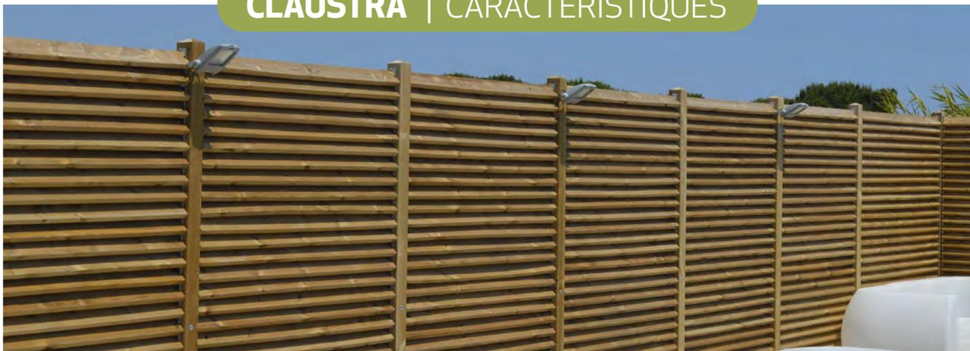
Panneau claustra composé de sections 95 x 28 mm en pin traité autoclave Classe 4, vissées de part et d'autre à l'aide d'un profilé en acier Zinc Magnésium
