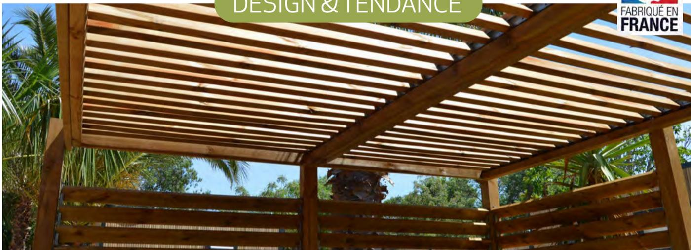
Pergola composée de poteaux section 90 x 90 mm, d'un cadre de toit en section 145 x 35 mm ainsi que de claustra. Disponible **avec ou sans claustras latéraux de style « persienne »** pour plus d'intimité (section utilisée 95 x 28 mm).
