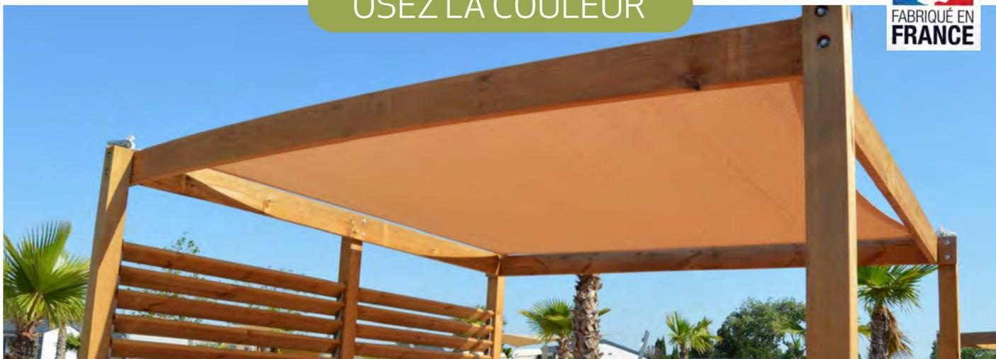
Pergola composée de poteaux section 90 x 90 mm, d'un cadre de toit en section 145 x 35 mm ainsi que d'une **toile en textile micro perforée**. Disponible **avec ou sans claustras latéraux de style « persienne »** pour plus d'intimité (section utilisée 95 x 28 mm).
